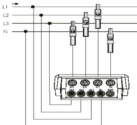
**3.-** Una vez conectado el analizador, vaya a la pantalla de datos en tiempo real y verifique que los datos mostrados son coherentes o dentro del rango esperado. En caso contrario, repase el conexionado de los cables y pinzas de medida a la red.
